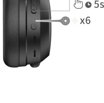
Com o aparelho ligado, pressione os botões "+" e "-" por 5s para concluir a redefinição, em seguida os headphones entrarão automaticamente no modo de emparelhamento Bluetooth se o procedimento for bem-sucedido.
